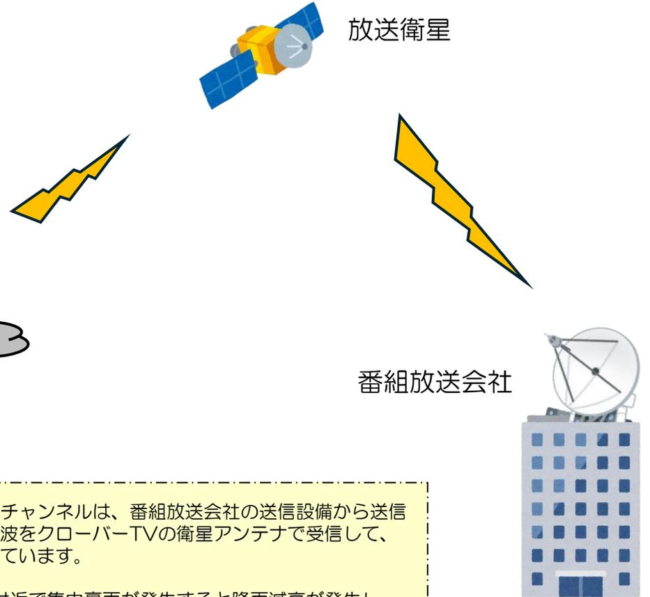
クローバーTVのBS放送のチャンネルは、番組放送会社の送信設備から送信され放送衛星を経由した電波をクローバーTVの衛星アンテナで受信して、お客さまのお宅にお届けしています。
